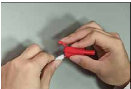
05 按压护套外壳尾端扣上盖子
