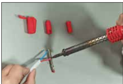
02 将含有两股线芯的电源线其中一根线芯接上金属条中间小孔。
